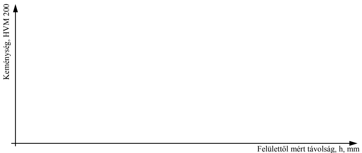
3.1. ábra Az alapkeménység és a nitridált kéreg vastagságának meghatározása
